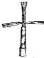
Рис. 14. Разделка свинцовой оболочки кабеля для заземления
